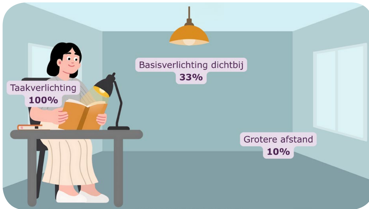
Figuur 2-4: Schematische weergave van een 10:3:1 lichtverhouding met een vrouw die in een kamer een boek leest aan tafel. 100% voor taakverlichting, 33% voor basisverlichting dichtbij, 10% op grotere afstand.
