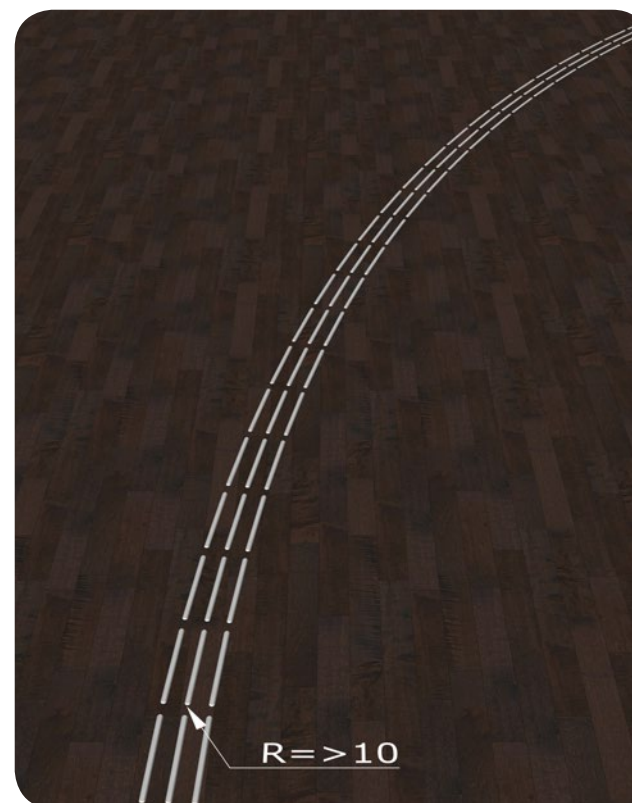
Afbeelding 8: Principe van een ronde bocht met een radius van minimaal 10 meter. Zonder onderbreking.
