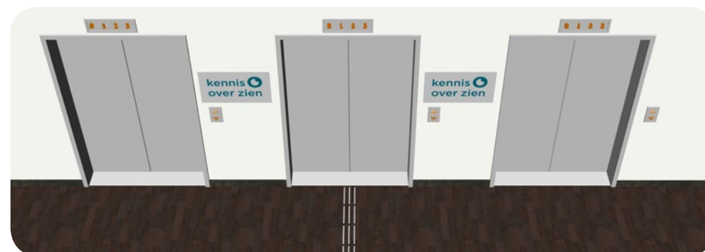
Afbeelding 18: Situatie met 3 liftdeuren, waarbij de geleidelijn loopt naar het centrum van de middelste liftdeur op de toegankelijke route.
