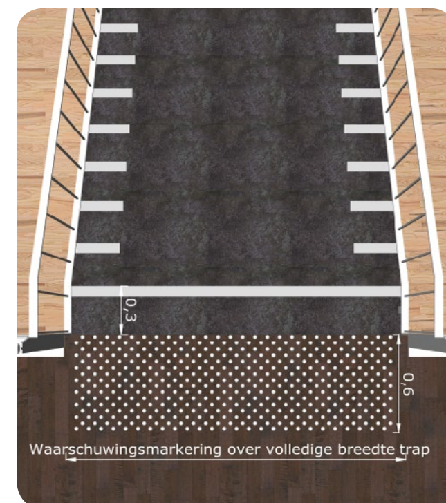
Afbeelding 19: Principe van waarschuwingmarkering bovenaan de trap, 30 cm vanaf de bovenste tredeneus.
