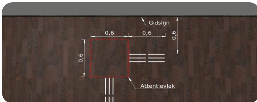
Afbeelding 3: Principe van een haakse aansluiting van geleidelijn op gidslijn, waarbij iemand maar één kant op kan. Met een attentievak van 60 cm breed en 60 cm diep die een hoek vormt in de geleidelijn
