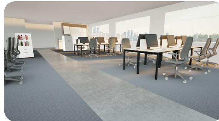
Afbeelding 33: Gidslijn in de vorm van voelbaar verschil in ondergrond tussen verblijfsgebied en verkeersgebied. Glad linoleum en stroef tapijt.
