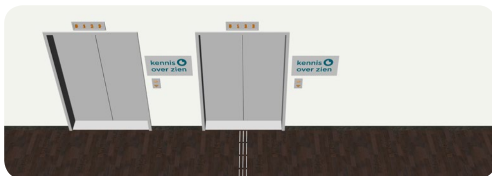
Afbeelding 17: Situatie met 2 liftdeuren, waarbij de geleidelijn loopt naar het centrum van de liftdeur die het meest dicht bij de toegankelijke route loopt.
